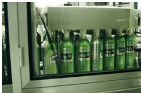
Varje flaska testas automatiskt upp till +50°C i vattenbad.
